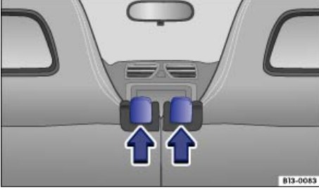
Şek. 79 Arka koltuk grubu: Koltuk sırtlığı kilidinin açılması.
