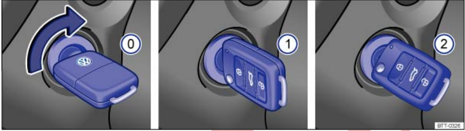
Şek. 99 Araç anahtarının kontak kilidindeki konumları
