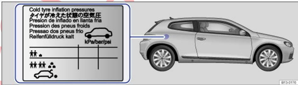
Şek. 146 Depo kapağındaki lastik dolum basıncı etiketi
