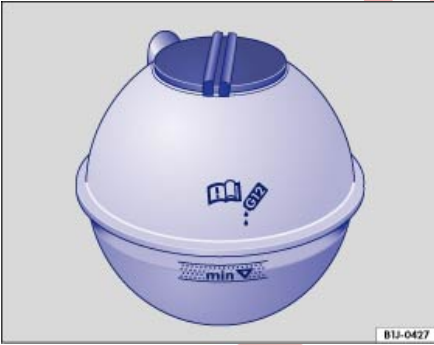
Şek. 137 Motor bölümünde: Motor soğutma suyu genişleme kabındaki işaret.
