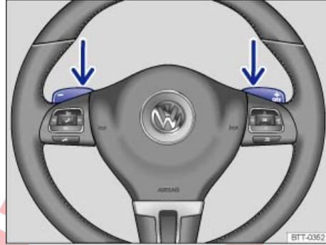
Şek. 107 Tiptronic için 2 vites düğmeli direksiyon.
