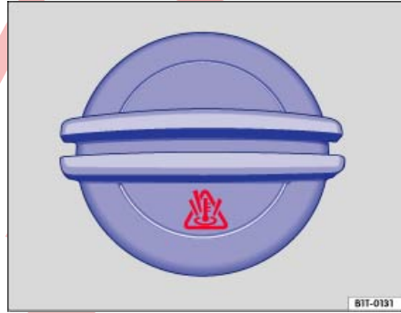
Şek. 138 Motor bölümünde: Motor soğutma suyu genişleme kabı kapağı.
