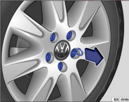
Şek. 170 Bijon koruyucu başlıklarının çekilerek çıkarılması.
