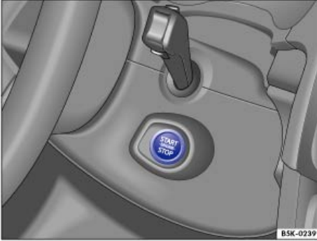
Şek. 100 Keyless Access – Anahtarsız giriş, kilitleme ve çalıştırma sistemi: Çalıştırma düğmesi
