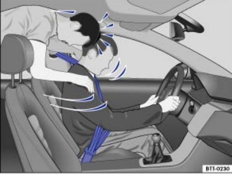
Şek. 50 Arka koltukta emniyet kemeri takılı olmayan yolcu, önde emniyet kemeri takılı olan sürücüye doğru savrulur.
