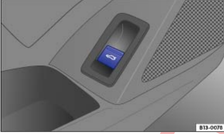
Şek. 28 Sürücü kapısında: Bagaj kapağı kilidini açma tuşu.
