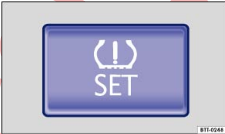
Şek. 124 Orta konsolda veya ön yolcu tarafı eşya gözünde: Lastik kontrol göstergesi tuşu
