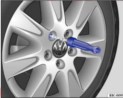
Şek. 177 Tekerlek değişimi: Bijonların tornavida-nın sapı ile çıkartılması.
