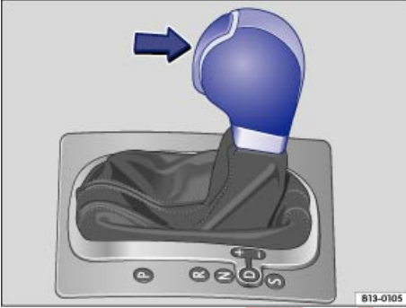
Şek. 105 Soldan direksiyonlu modeller: Kilit düğmesine sahip otomatik şanzıman vites kolu (ok) Sağdan direksiyonlu araçlarda simetrik.
