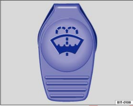
Şek. 75 Motor bölümünde: Cam yıkama suyu haznesi kapağı.
