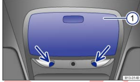
Şek. 27 Tavan konsolunda: Saklama bölmesindeki iç alan izleme sistemi sensörleri.
