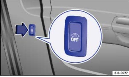
Şek. 26 Sürücü koltuğu yanında: İç alan izleme ve çekme alarmı devre dışı bırakma düğmesi.
