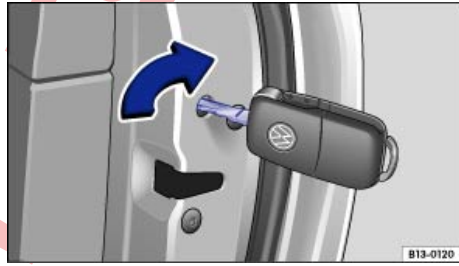
Şek. 158 Acil bir durumda ön yolcu kapısının araç anahtarı ile kilitlemesi.
