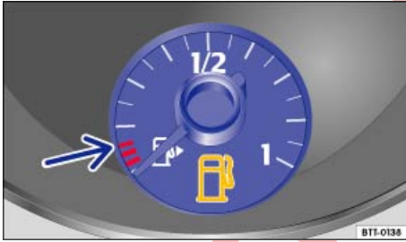
Şek. 129 Gösterge tablosunda: Benzin ve dizel yakıt için yakıt göstergesi
