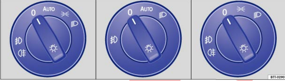
Şek. 66 Direksiyonun yanında: Far düğmesi versiyonları.
