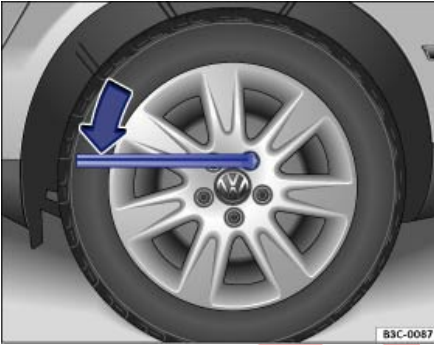
Şek. 171 Tekerlek değişimi: Bijonların gevşetilmesi.
