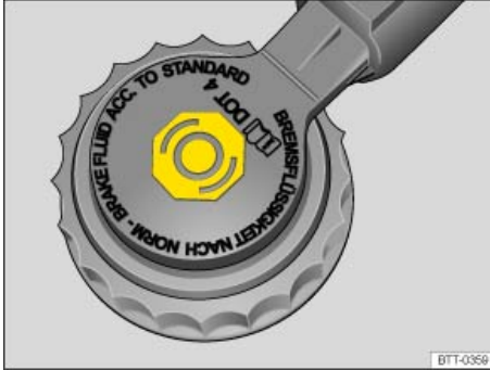
Şek. 111 Motor bölümünde: Fren hidroliği haznesi kapağı
