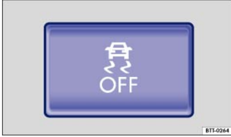
Şek. 109 Orta konsolda: ASR fonksiyonunu veya elektronik stabilizasyon programını (ESC) manuel açma ve kapatma tuşu.
