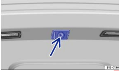
Şek. 117 Arka tampondaki plaka aydınlatmaları arasında: Geri sürüş asistanı kamerasının montaj yeri.
