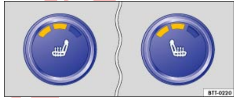
Şek. 44 Orta konsolda: Ön koltuk ısıtma düğmeleri (Versiyon 2).
